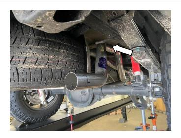
**STEP 6:**SLIP A CLAMP ONTO THE RIGHT SIDE TIP AND INSERT INTO THE RUBBER ISOLATOR.
