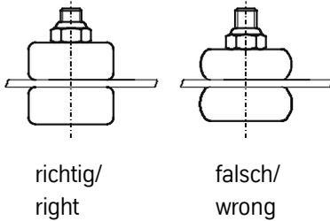
1. Kolbenstangenmutter \*B
