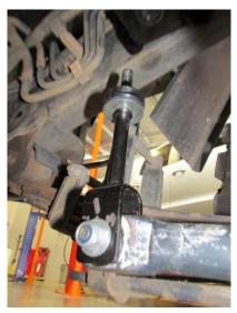
2. FIT THE SWAY BAR LINKS TO THE SWAY BAR AS SHOWN.
