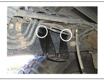
1. FIT THE HEAVY DUTY SWAY BAR DROPPER BRACKETS USING THE M8 **BOLTS, SPRING & FLAT WASHERS** PROVIDED.
