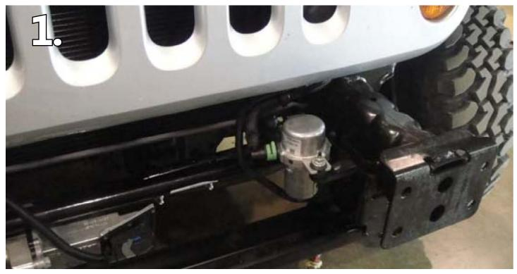
**BEGIN BY REMOVING THE GREEN CLIP THAT SECURES** THE VACUUM LINE TO THE SWITCH. SIMPLY SLIDE THE CLIP DOWN AND PULL THE LINE OFF THE SWITCH.
