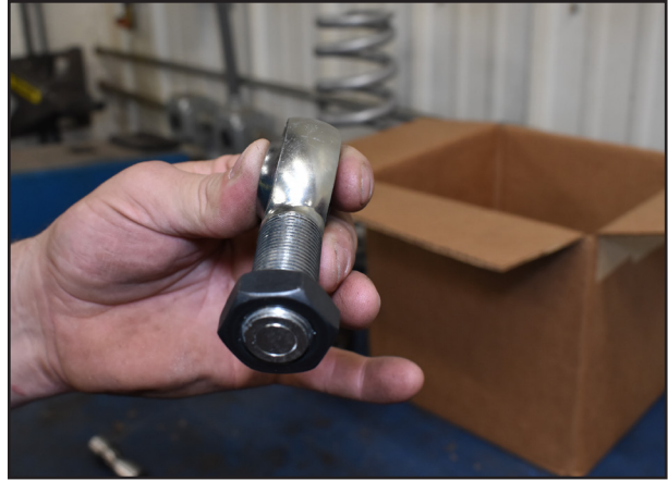
Fig. 11: Install jam nut.
