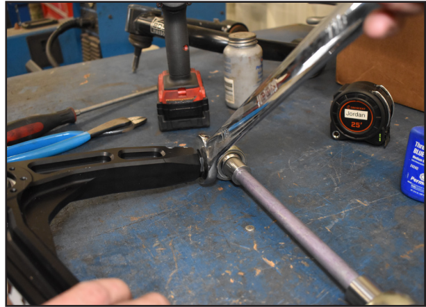
Fig. 15: Tighten jam nut.
