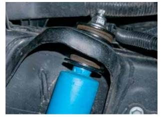
Fig. 10: Remove stem top nut.
