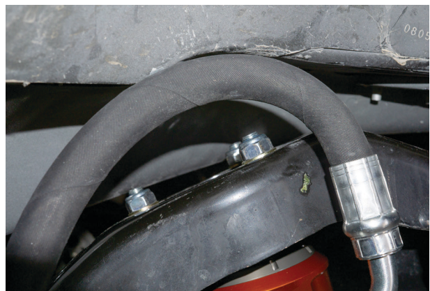
Fig. 37: Attach the top hat nuts.
