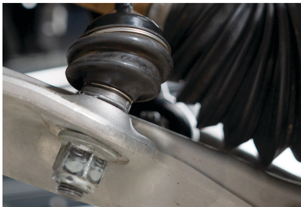
Fig. 17: Sway bar end link.
