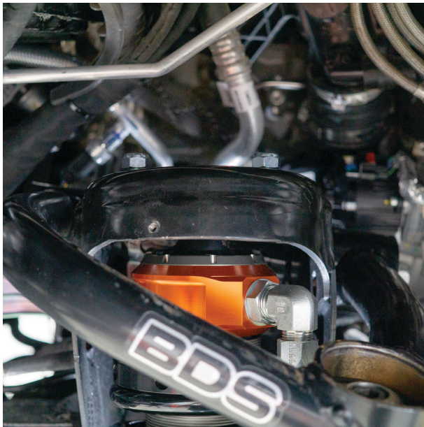
Fig. 12: Mount the top hat nuts.
