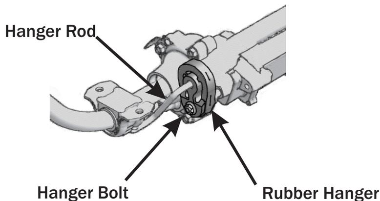
1. Remove smart bar hanger bolt.
