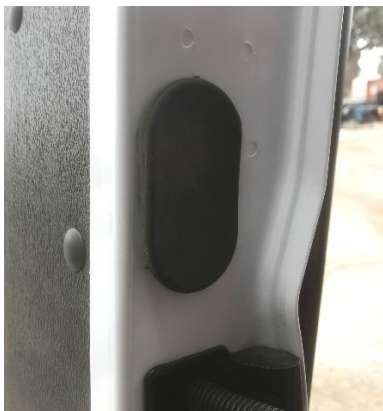
Figure 18: Remove Rubber Door Grommet
